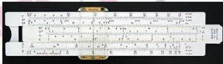
Abbildung 3: Rechenschieber mit logarithmischen Zahlen
